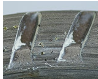
Schneide mit eingebetteten Diamanten
